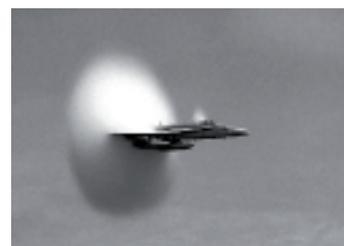
Un F/A-18 Hornet está a punto de romper la barrera del sonido sobre las aguas del Pacífico. La “niebla” que se observa detrás del avión está producida por la condensación del vapor de agua, causada por la caída repentina de presión que tiene lugar detrás de la onda de choque cuando se está llegando a Mach 1. Este fenómeno recibe el nombre de *singularidad de Prandtl-Glauert* y todavía no está descrito perfectamente.
