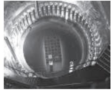
Brillo azulado producido por la radiación Cherenkov en el reactor de la central nuclear de Gösigen, en Suiza
